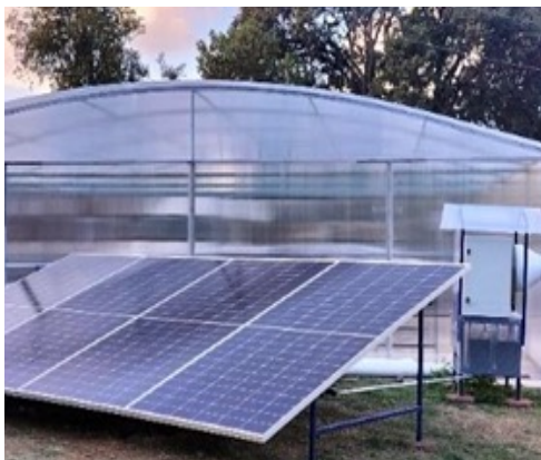
Figura 5. Secador solar tipo túnel en una prueba de secado con irradiación de 12.3 \text{ MJ/m}^2 , humedad relativa ambiental de 48.6 % y una temperatura ambiente de 34.2^\circ\text{C}
